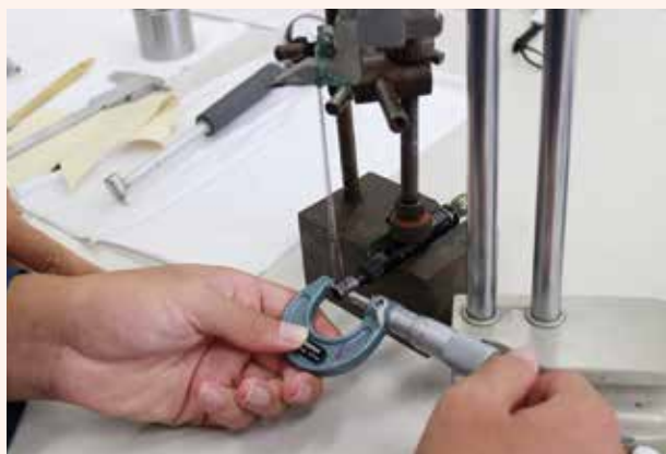
マイクロメータによる計測
